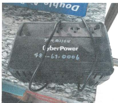
เครื่องสำรองไฟฟ้า ขนาด ๘๐๐ VA
